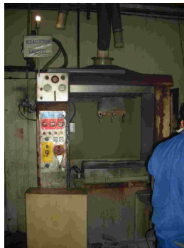
Figura 15 - Máquina de deposição de cobre Fonte – arquivo pessoal
