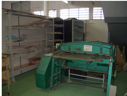
Figura 7 - Guilhotina para corte das chapas laminadas e material auxiliar
