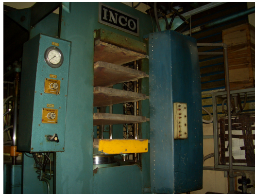
Figura 10 - Prensa do Multicamadas com cilindro de óleo térmico
